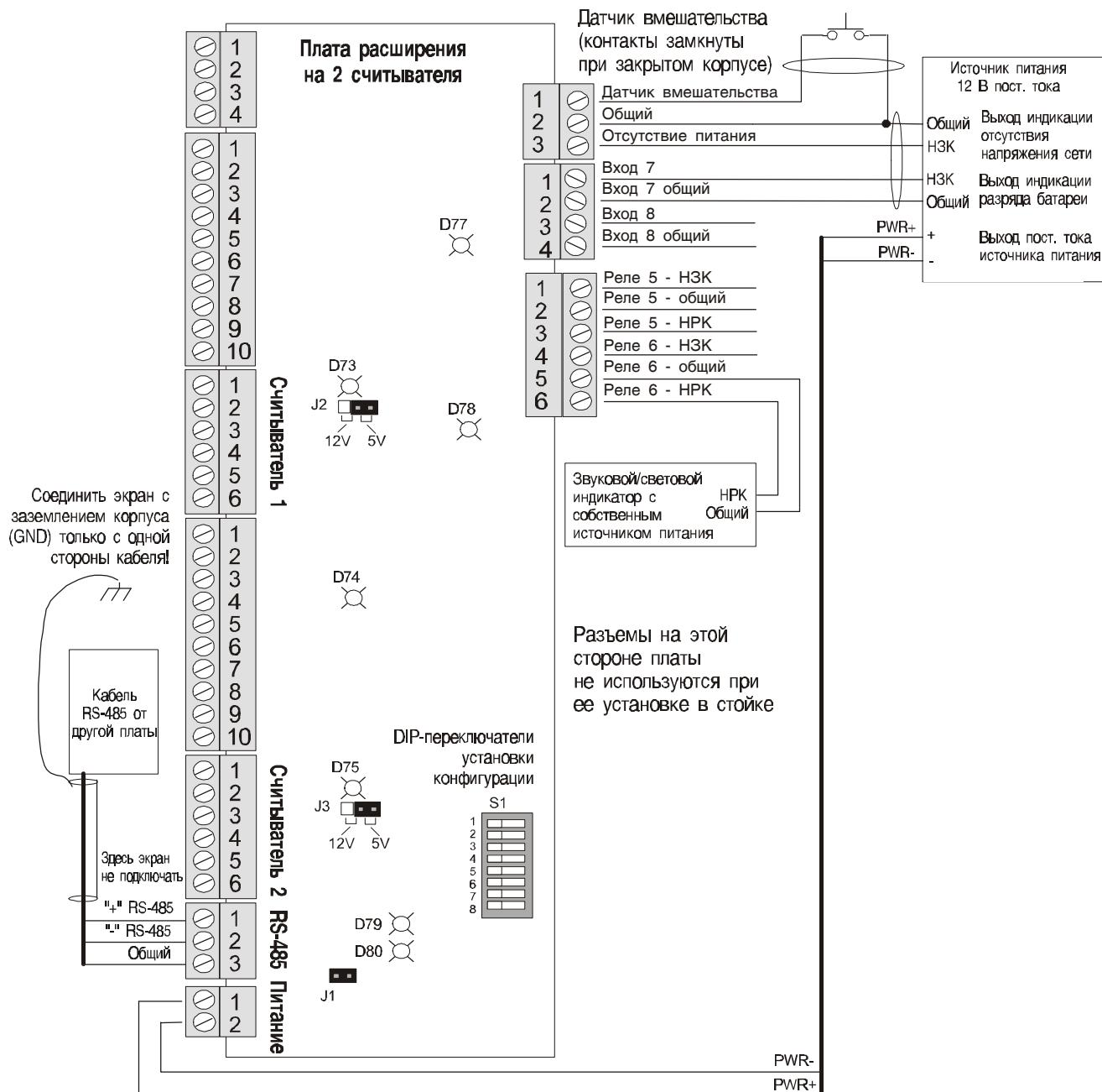
**Примечание.** Для подключения к N-485 соедините вместе провода синего цвета и используйте их как общий провод (сигнальное заземление). Используйте оранжевую пару проводов для передачи данных, соблюдая полярность подключения. На одном конце линии соедините внешнюю оплетку проводников с электрическим заземлением.
