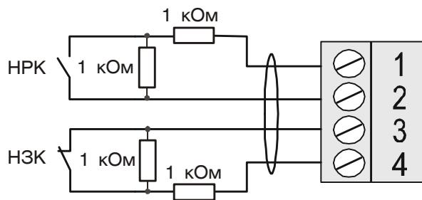
По умолчанию вход 1 используется для подключения датчика состояния двери, соответствующей считывателю 1. Ко входу 2 подключается кнопка запроса на выход для двери 1. Аналогично, ко входу 3 по умолчанию подключается датчик состояния двери 2, а ко входу 4 – кнопка запроса на выход для двери 2.
