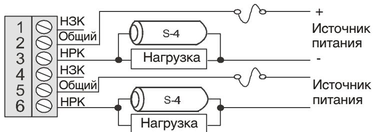
Реле 2 и 4 обычно используются для индикации состояния замка двери. Реле 5 и 6 могут использоваться для любых функций. Они недоступны при установке платы PW5K1R2 в стойке в корпусе PW5K1ENC1.
