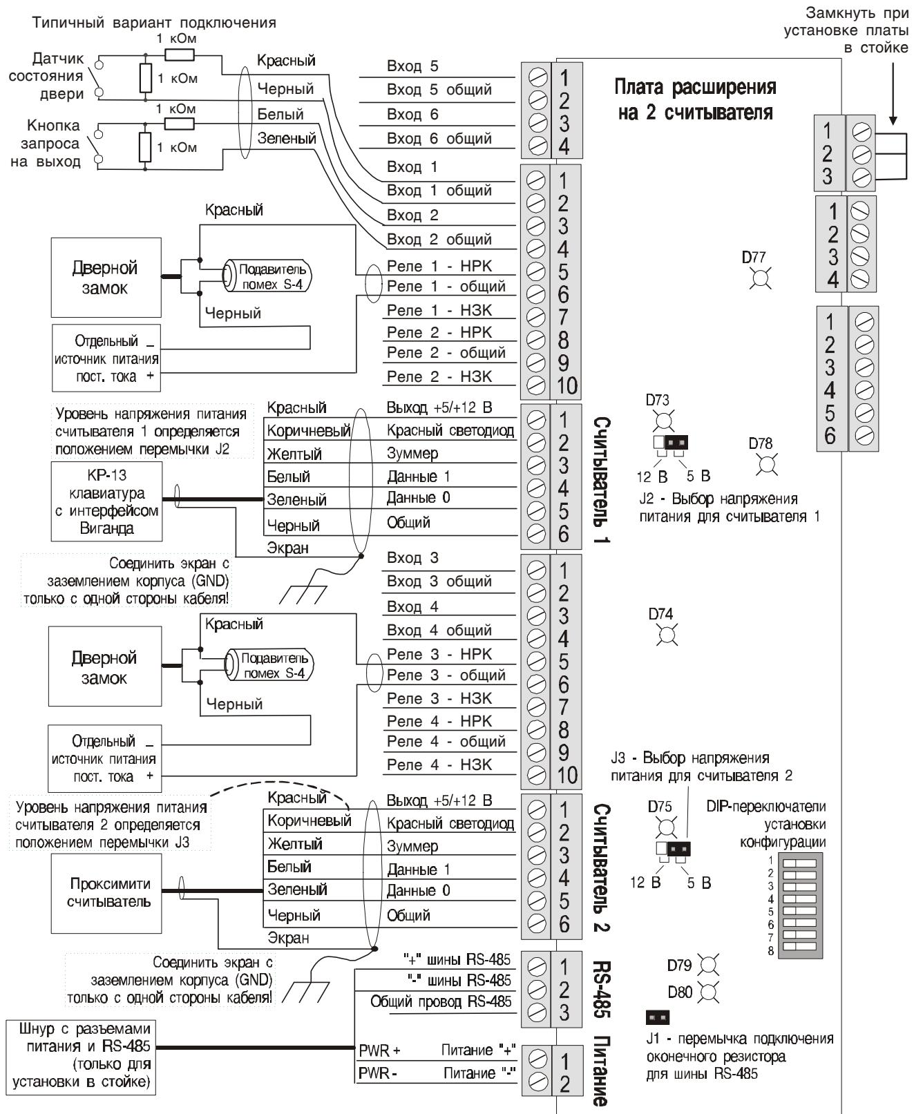
**Примечание.** Для подключения к N-485 соедините вместе провода синего цвета и используйте их как общий провод (сигнальное заземление). Используйте оранжевую пару проводов для передачи данных, соблюдая полярность подключения. На одном конце линии соедините внешнюю оплётку проводников с электрическим заземлением.
