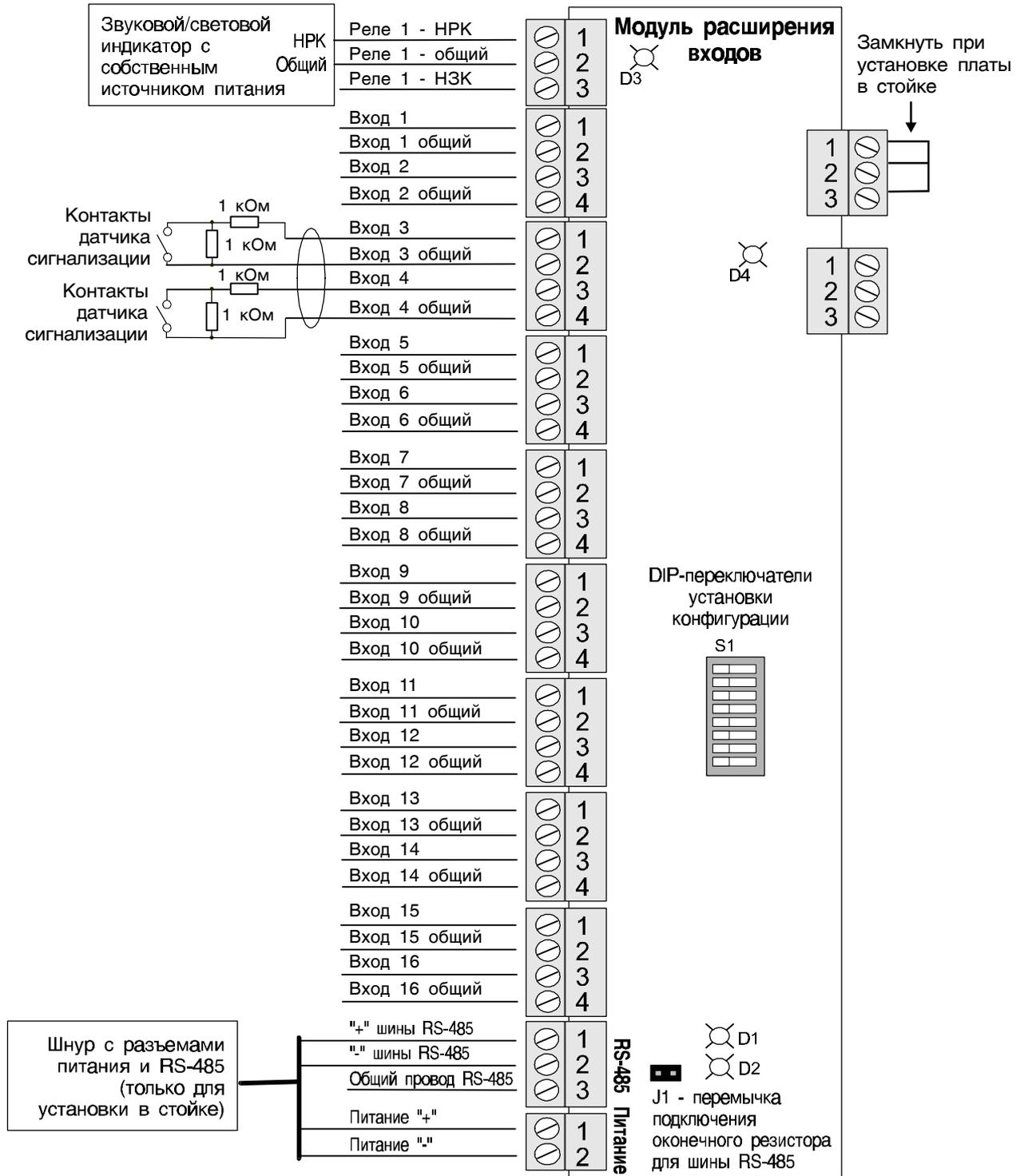
*Примечание.* Для подключения к N-485 соедините вместе провода синего цвета и используйте их как общий провод (сигнальное заземление). Используйте оранжевую пару проводов для передачи данных, соблюдая полярность подключения. На одном конце линии соедините внешнюю оплетку проводников с электрическим заземлением.
