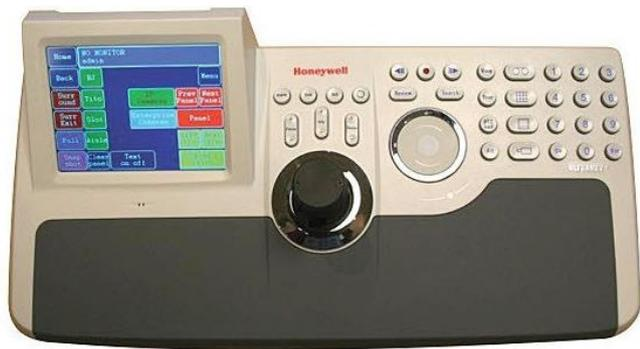
Для повышения автоматизации работы операторов используется клавиатура Ultrakey Plus. Благодаря возможности подключения по IP она может быть подключена к нескольким рабочим станциям одновременно, таким образом, с помощью одной клавиатуры можно управлять всей системой (нет необходимости подключать по джойстику к каждой рабочей станции). Функционал клавиатуры тесно интегрирован в ПО
