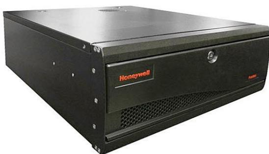
Honeywell Fusion DVR – гибридный 32-канальный видеорегистратор для подключения как аналоговых, так и IP-камер. В данном решении к нему подключаются 30 аналоговых камер. На нём же осуществляется обработка, архивирование и перекодировка видео для передачи на сервер MAXPRO (перекодировка существенно снижает нагрузку на локальную сеть и сервера обработки видео, поскольку от Fusion IV на MAXPRO поступает уже перекодированный, сжатый сигнал
