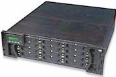
В любой видеосистеме хранение данных – одна из важнейших составляющих, поэтому к хранилищам предъявляются особенно высокие требования к надежности и долговечности. Система хранения данных Honeywell представляет собой высоконадежный RAID-массив, подключаемый напрямую к серверу через высокоскоростное подключение SCSI. Honeywell предлагает различные модели RAID-массивов от 4 до 24 дисков объемом до 24 Тб. В данном решении предлагается использовать по 1-му 12-дискovому массиву для каждого сервера.
