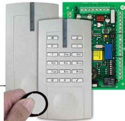
Контрольная панель Galaxy Dimension представляет собой интегрированное решение для создания систем охранно-пожарной сигнализации и контроля доступа. Контрольная панель имеет расширенные функции по контролю и управлению доступом, включая возможность использования считывателей с интерфейсом Виганда и программирования любой
