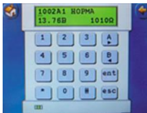
Рис. 2. Эмуляция клавиатуры МК7 на экране TouchCenter
