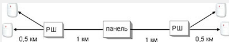
Рис. 3. Типовая структура системы на базе КП Galaxy Dimension
