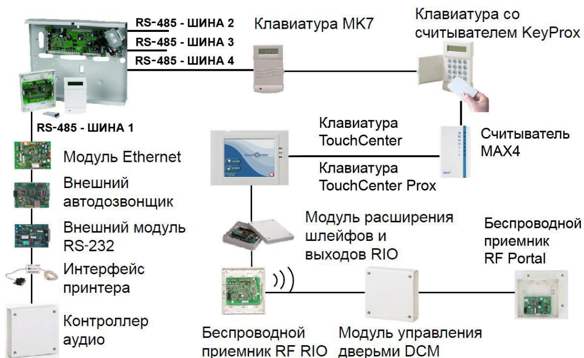
Рис. 1. Типовая структура системы на базе КП Galaxy Dimension
